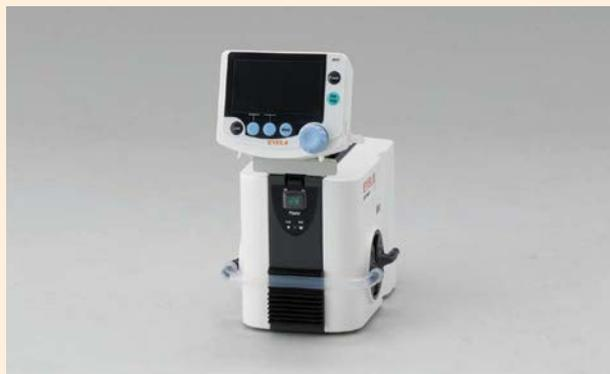
インバーターダイヤフラム型真空ポンプに真空コントローラー-NVC-3000型を一体化することで、減圧、圧力コントロール、圧力表示が行なえ各種減圧蒸留装置用の減圧装置として使用できます。真空コントローラーからインバーターダイヤフラム型真空ポンプの制御が行なえます。省スペースで持運びが容易なので、ドラフトチャンバーや実験台のスペースを有効活用できます。
